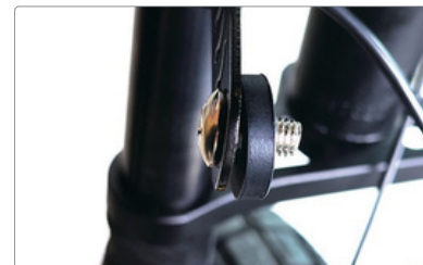
Posicione os parafusos na lateral do garfo
