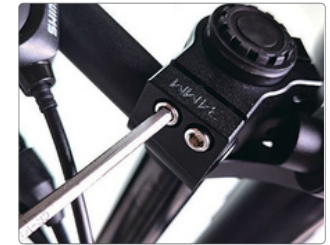
Prenda com os parafusos firmemente
