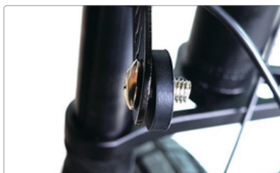
Posicione os parafusos na lateral do garfo
