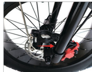
Posicione a asa metálica na lateral do garfo
